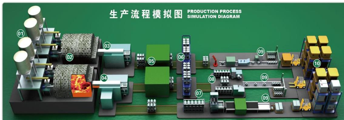
玻璃纤维是一种性能优异的无机非金属材料，种类繁多，优点是绝缘性好、耐热性强、抗腐蚀性好，机械强度高，其主要成分为二氧化硅、氧化铝、氧化钙、氧化硼、氧化镁、氧化钠等，根据玻璃中碱含量的多少，可分为无碱玻璃纤维、中碱玻璃纤维和高碱玻璃纤维，其中无碱玻璃纤维占据全行业 95% 以上的产量规模。玻璃纤维通常用作复合材料中的增强材料、电绝缘材料和绝热保温材料，电路基板等国民经济各个领域，是国家重点鼓励发展的新材料产业。它是用叶腊石、高岭土、石灰石、石英砂等矿石为原料（上图 1 各种矿石按照比例配制）经高温熔制（上图 2）、拉丝（上图 3 和 4）、烘干（上图 5 和 6）、络纱（上图 7）等工艺制造而成，其单丝直径为几微米到二十几微米，相当于一根头发丝的 1/20-1/5，每束纤维原丝都由数百根甚至上千根单丝组成。
